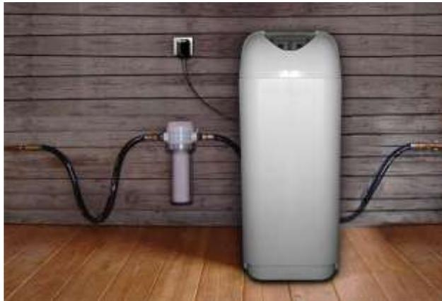
Généralement branché au point d'arrivée d'eau du logement, l'**adoucisseur** « filtre » l'eau calcaire et produit de l'eau adoucie qui n'entraîne ni traces de calcaire, ni **dépôt de tartre**. Il est réputé pour être très consommateur d'eau (rejets). Il **augmente la consommation en eau** par ses cycles de régénération qui peuvent utiliser jusqu'à 200 litres d'eau.
