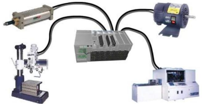
On utilise les API dans tous les secteurs industriels pour la commande des machines (convoyage, emballage...) ou des chaînes de production (automobile, agroalimentaire ...) ou il peut également assurer des fonctions de régulation de processus (métallurgie, chimie ...). Il est de plus en plus utilisé dans le domaine du bâtiment (tertiaire et industriel) pour le contrôle du chauffage, de l'éclairage, de la sécurité ou des alarmes.
