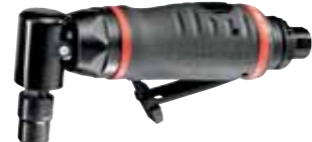
Meuleuse 0.3 CV à angle 90° confort à pince, 6 mm, 0,555 kg
